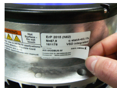
Пример: Размещение наклейки FCC/IC "AM-MODBUS-W inside" на корпусе вентилятора.
